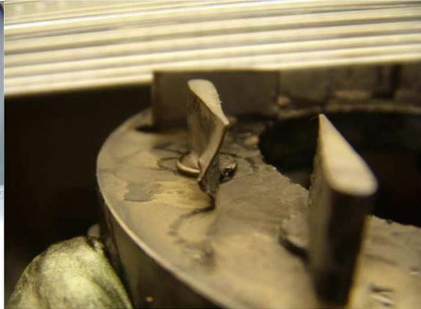
Turbine d'échappement endommagée.
