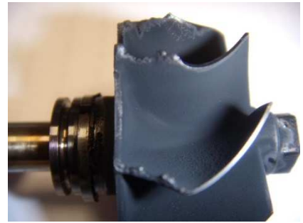
Turbine d'échappement endommagée
