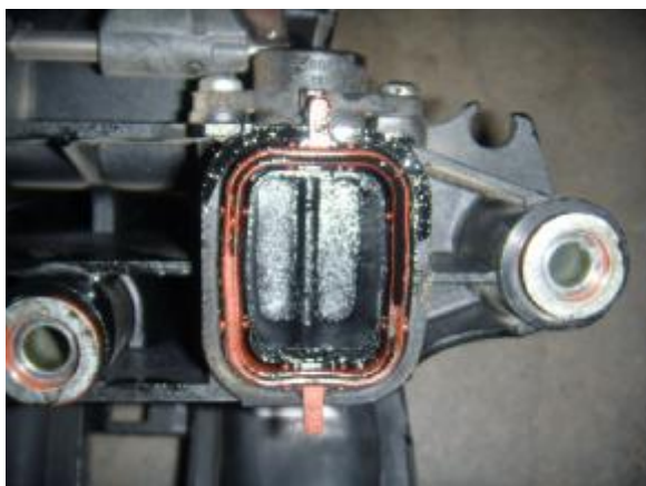
Collecteur d'admission d'air en plastique, avec volet de turbulence additionnel.
